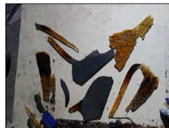
モジュールから脱落したガラス片
